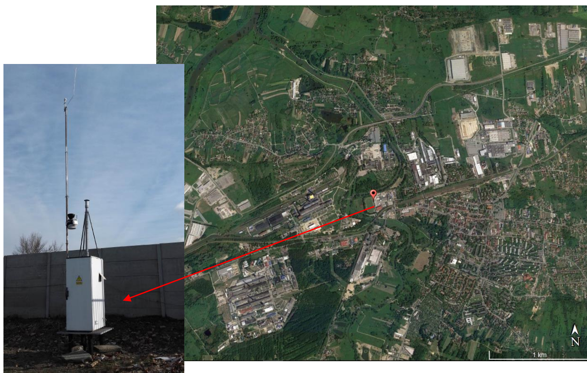
Rysunek 5. Lokalizacji stacji pomiarowej oraz widok na pobornik nisko-przepływowy \mu PNS LVS16
