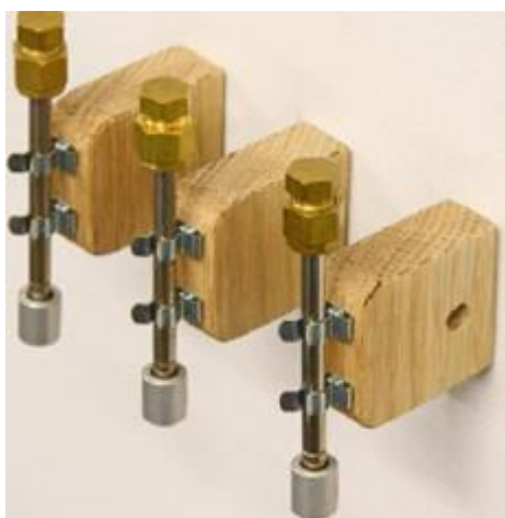
Rysunek 1. Rurki do oznaczania lotnych i pół-lotnych związków organicznych
